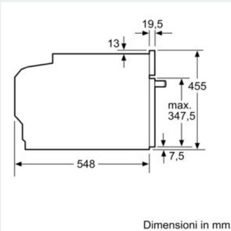
Se l'apparecchio compatto viene montato sotto un piano di cottura deve essere rispettato il seguente spessore del piano di lavoro (event. incl. sottostruttura).
