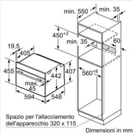
Montaggio con un piano di cottura.
