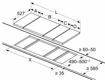
Se due o più elementi sono installati uno accanto all'altro, sono necessari uno o più kit di installazione (2 elementi 1 kit di installazione, 3 elementi 2 kit di installazione, ecc.)
