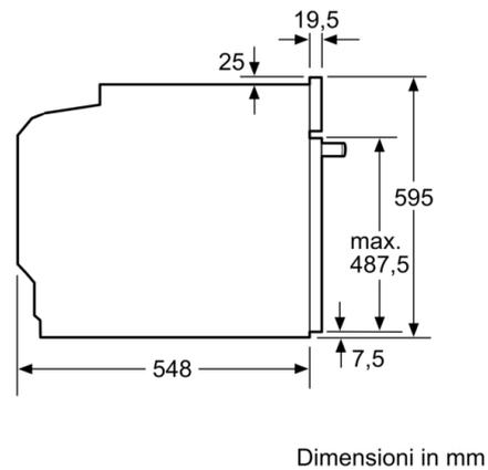
Montaggio con un piano di cottura.
