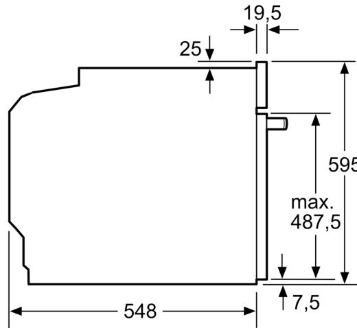
Montaggio con un piano di cottura.
