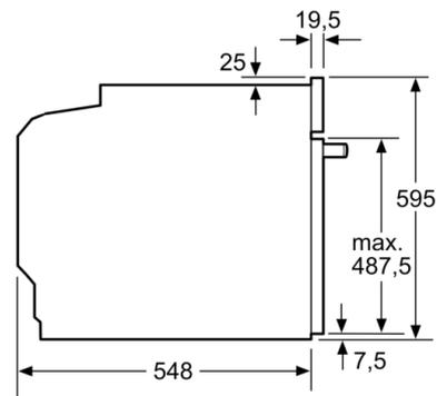
Montaggio con un piano di cottura.
