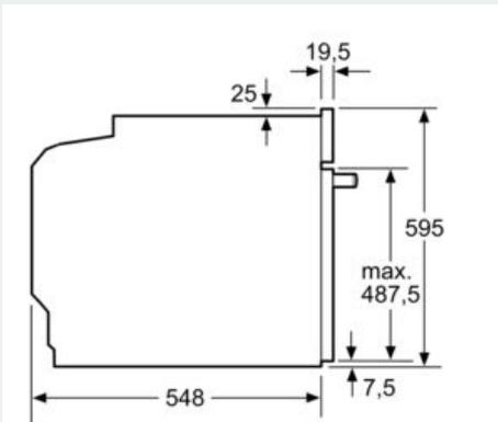
Montaggio con un piano di cottura.
