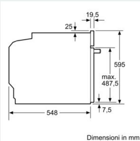
Montaggio con un piano di cottura.
