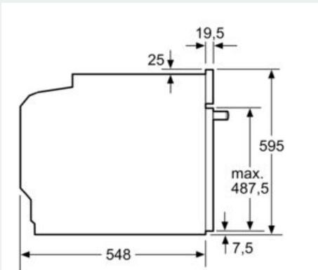
Montaggio con un piano di cottura.
