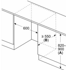
A: Altezza sottostruttura
