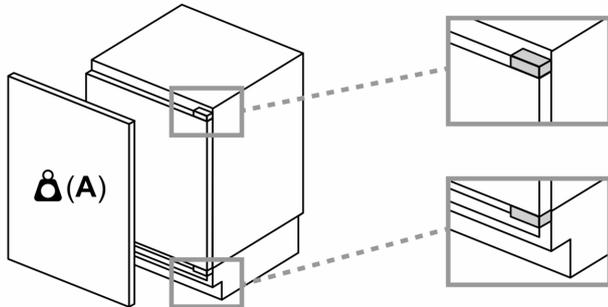
I frontali montati dell'unità che superano il peso consentito possono causare danni e compromettere il funzionamento delle cerniere
