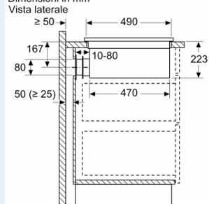
Se si effettua l'installazione direttamente contro pareti esterne non coibentate ( $\mu \geq 0.5 \text{ W/m}^2 \text{ } ^\circ\text{C}$ ), consigliamo di usare configurazioni con ricircolo parzialmente o completamente canalizzato.
