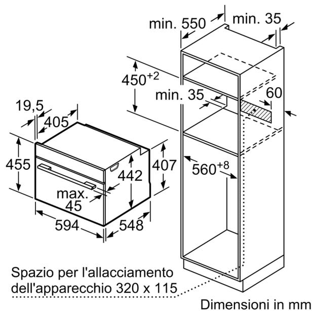
Montaggio con un piano di cottura.
