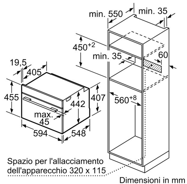
Montaggio con un piano di cottura.
