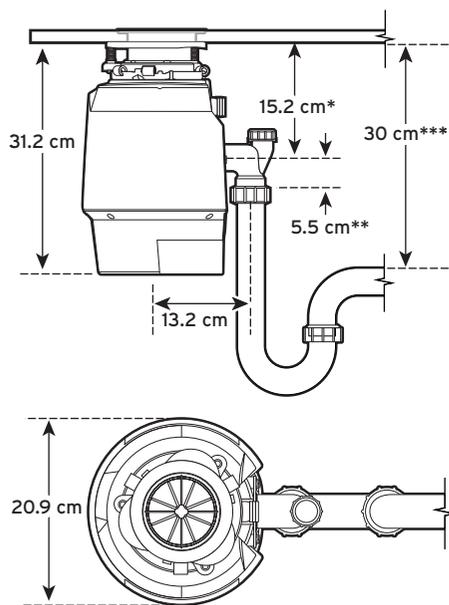
\* Distanza dal fondo del lavello alla mezzeria dello scarico del dissipatore. Aggiungere 12,7 mm se si utilizza un lavello in acciaio inossidabile.
